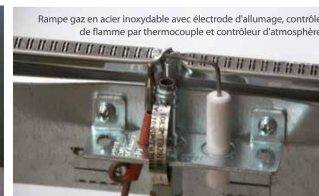
Rampe gaz en acier inoxydable avec électrode d'allumage, contrôle de flamme par thermocouple et contrôleur d'atmosphère
