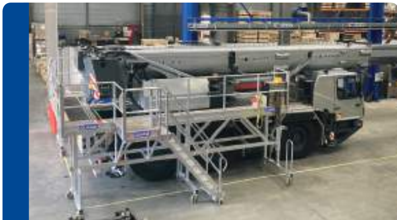
Plate-forme pour maintenance sur grues mobiles automotrices routières
