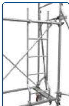
L'accès au 1 er niveau se fait par une échelle rapportée. Sa position décalée libère la traversée sur toute la longueur de l'échafaudage.
