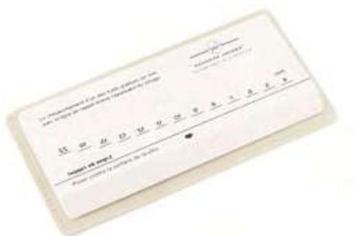
PERMET DE MESURER L'ÉPAISSEUR DES VITRAGES EN LECTURE DIRECTE ET L'ESPACE D'AIR ENTRE LES 2 VITRAGES. PERMET DE DÉDUIRE L'ÉPAISSEUR DES DOUBLE-VITRAGES
