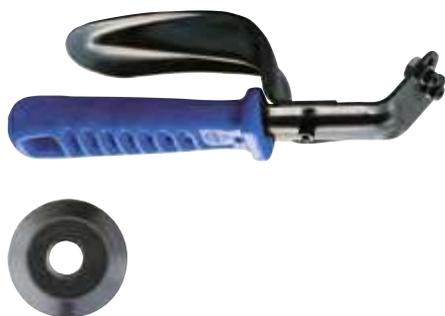
ÉBAVURAGE SIMULTANÉ DES 2 CÔTÉS EXTÉRIEURS DE LA TÔLE. CAPACITÉ DE 0 À 12MM. LES LAMES SONT AFFÛTÉES SUR LES 2 FACES. PROTECTION DE LA MAIN. UTILISABLE AVEC UNE SEULE LAME POUR LES ANGLES.
