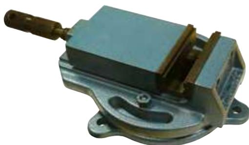
MORS EN ACIER TREMPÉ RECTIFIÉ RÉVERSIBLES. MÂCHOIRE FIXE : 1 FACE LISSE, AUTRE FACE STRIÉE. MÂCHOIRE MOBILE : 1 FACE RAINURÉS EN V VERTICALES ET HORIZONTALES, L'AUTRE FACE LISSE. FIXATION LATÉRALE. PROTECTION DE LA VIS DE SERRAGE.
