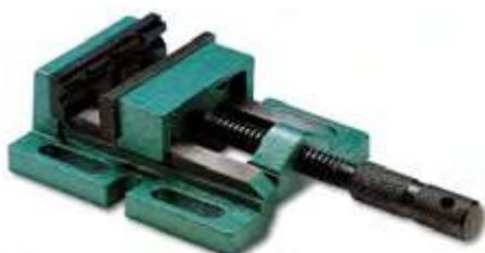
MORS EN ACIER TREMPÉ RECTIFIÉ. MÂCHOIRE MOBILE : 1 FACE LISSE, 1 FACE STRIÉE. MÂCHOIRE FIXE : 1 FACE RAINURÉS EN V VERTICALES ET HORIZONTALES, L'AUTRE FACE LISSE. FIXATION LATÉRALE.
