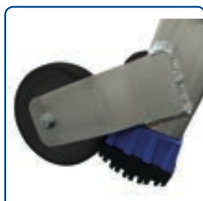
Roues Ø 125 mm. Larges patins antidérapants bi-matière avec témoin d'usure
