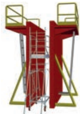
Ample passage libre (haut. 1,74 m) sous le plancher pour permettre travail et circulation entre les banches.
