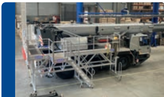
Plate-forme pour maintenance sur grues mobiles automotrices routières
