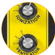
**Réglage de l'intensité de l'ionisation et de la puissance du ventilateur**
