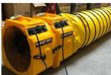
Deux unités connectées pour augmenter la pression d'air - cela permet de connecter plus d'une Gaine flexible pour ventiler des distances plus longues.
